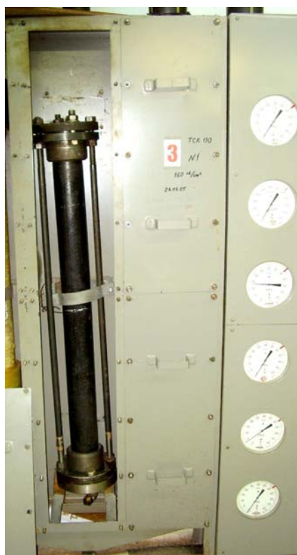
Рис. 5 Образец для исследования поведения подземного трубопровода из ПАСНТ
